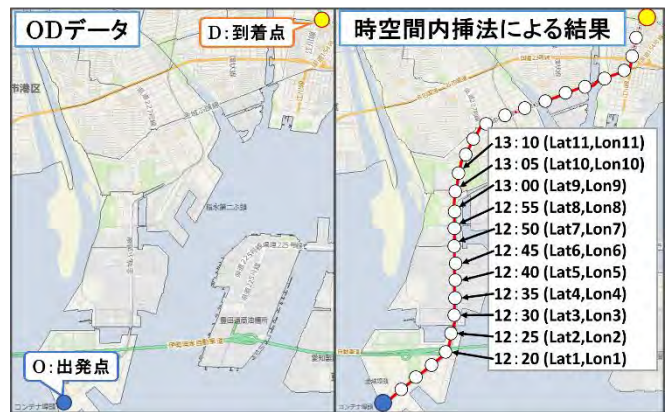
図-4 時空間内挿法の概念図
